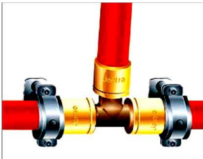
Fig. 11.4 – Instalarea suporturilor fixe pe conducte din polietilenă reticulată
