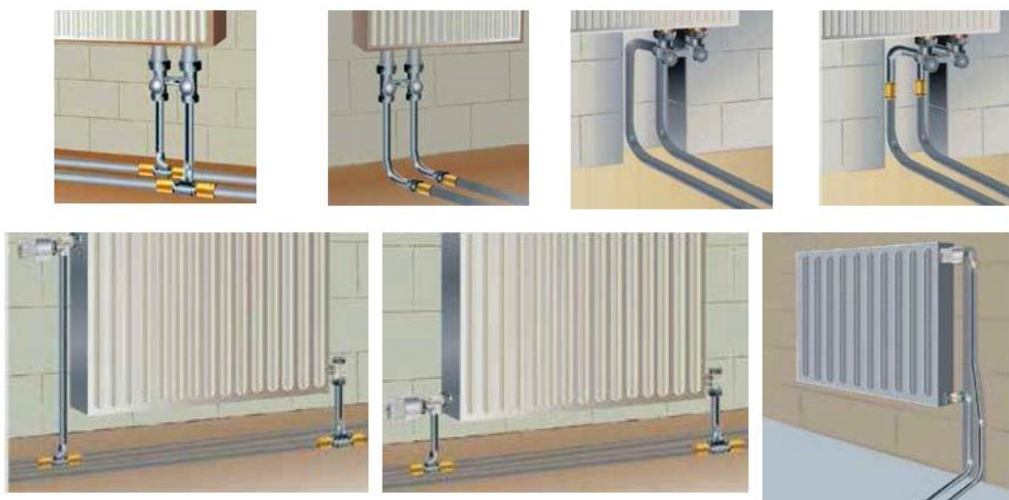
Рис. 11.10 – Варианты подключения приборов отопления с донным и боковым подключением
