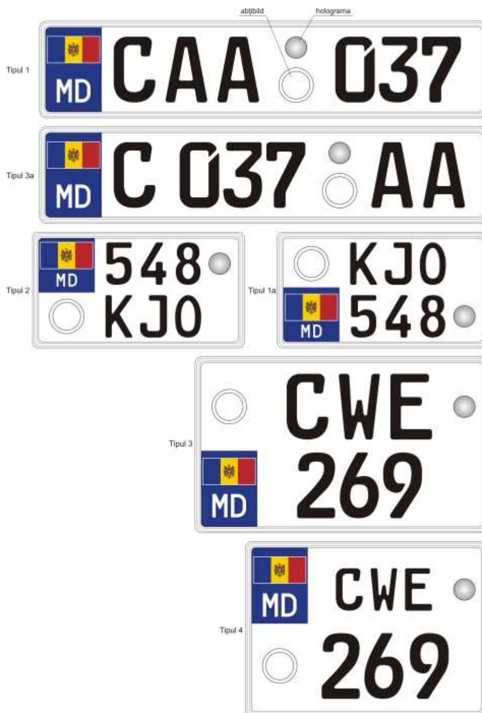
Figura B.1 – Amplasarea numărului de înmatriculare pe plăcile de înmatriculare pentru autovehiculele persoanelor fizice și juridice ale Republicii Moldova
