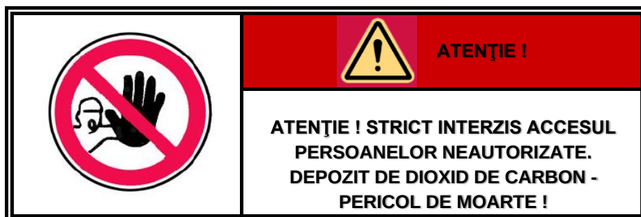
Figura 11.2 - Indicator pentru avertizare pentru spațiile în care se depozitează butelii cu dioxid de carbon
