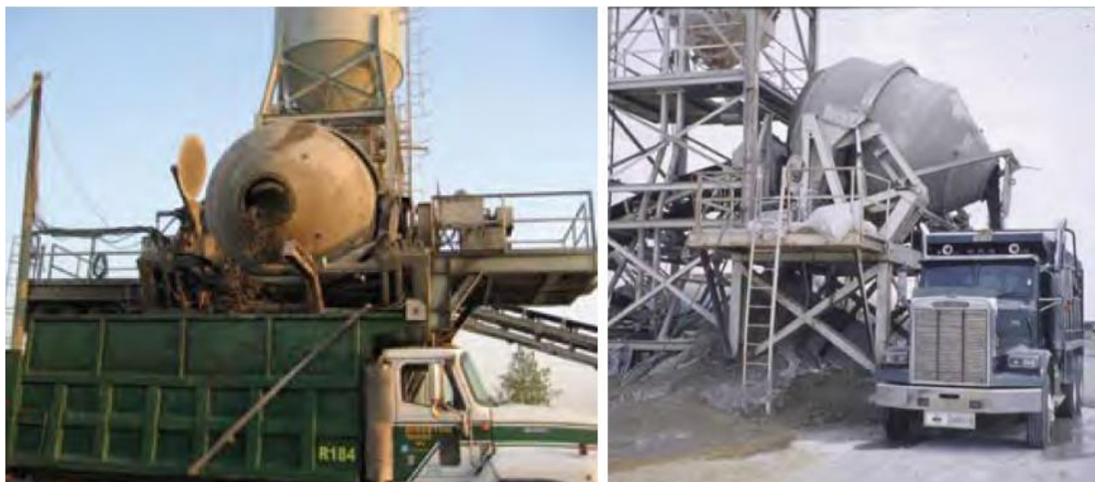
Рисунок 11 - Смеситель с наклонным барабаном
