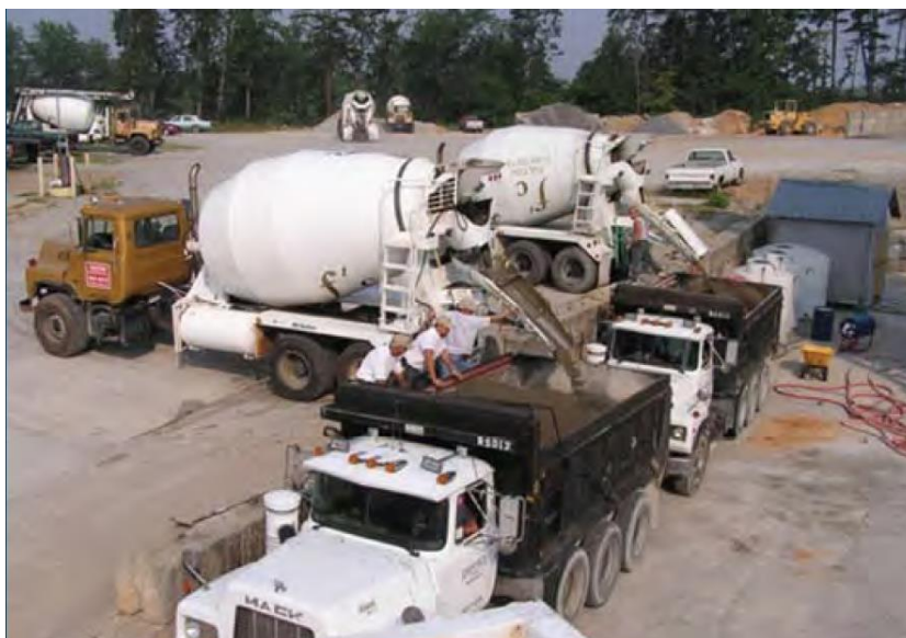
Рисунок 12 - Загрузка грузовиков из автобетоносмесителей
