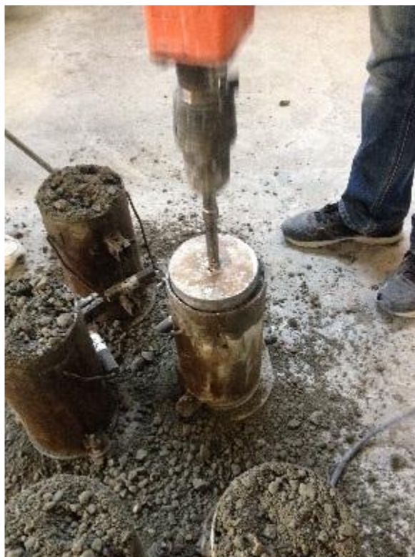
Рисунок 8 - Изготовление цилиндрического образца из смеси RCC с помощью вибромолота
