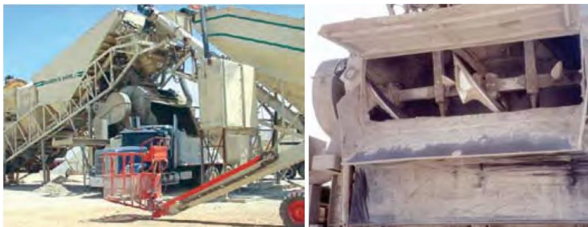
Figura 14 - Mixer cu ax orizontal (stânga) și vedere de aproape a camerei de amestecare (dreapta)
