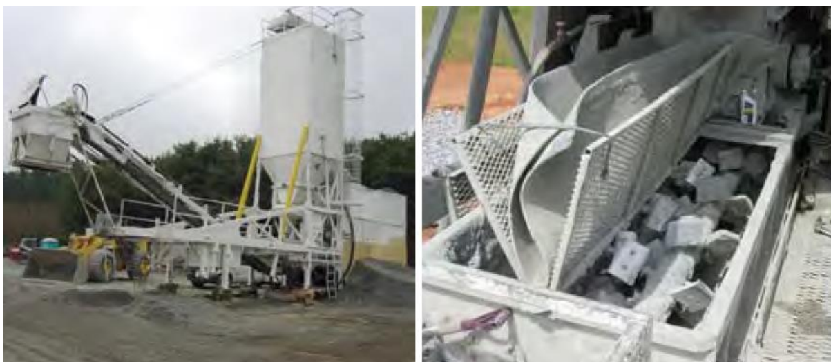
Figura 13 - Fabrica mobilă de beton (stânga) și vedere de aproape a camerei de amestecare (dreapta)
