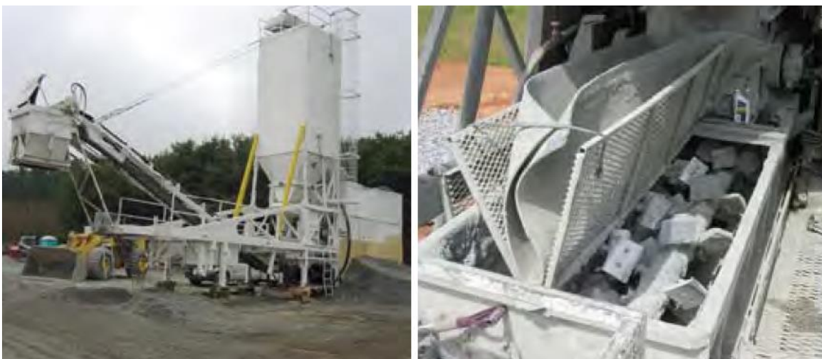
Рисунок 13 - Смеситель непрерывного действия (слева) и крупный план смесительной камеры (справа)
