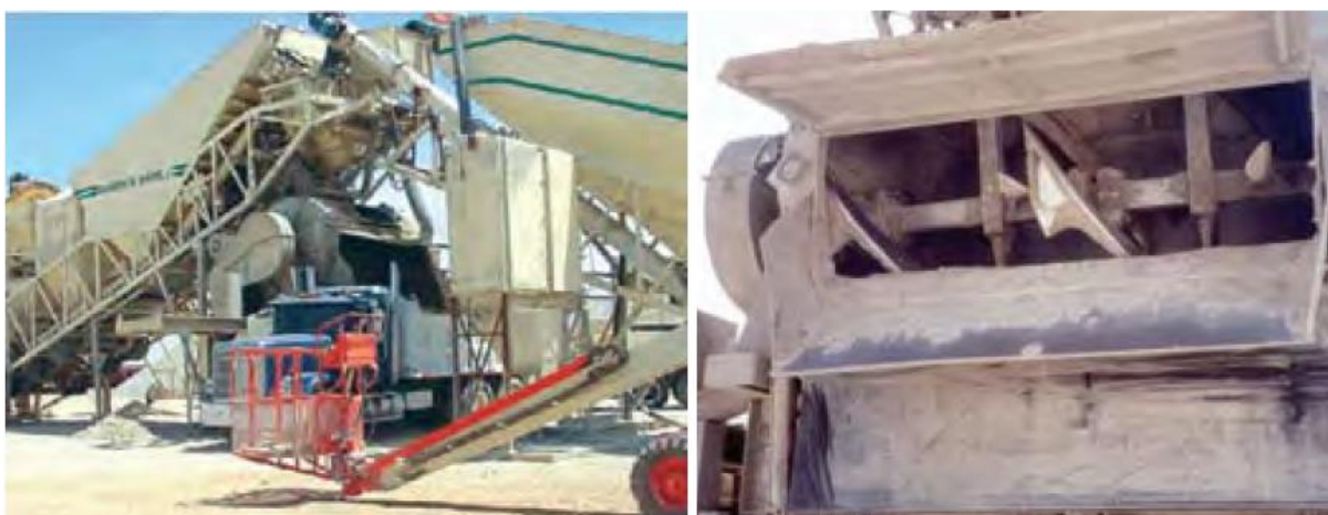
Рисунок 14 - Смеситель с горизонтальным валом (слева) и камера смешения крупным планом (справа)
