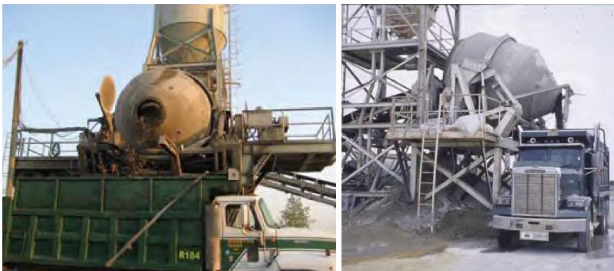
Figura 11 – Betonieră cu tambur înclinat
