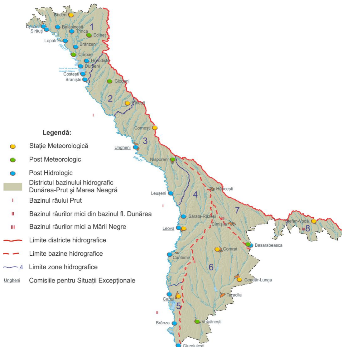
Figura nr. 11 Rețeaua de monitoring a secetei din Districtul bazinului hidrografic Dunărea-Prut și Marea Neagră
