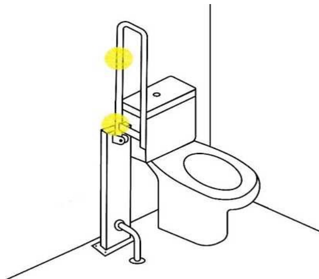
Рисунок А.18 — Откидной поручень без устройства фиксации в вертикальном положении недопустим
