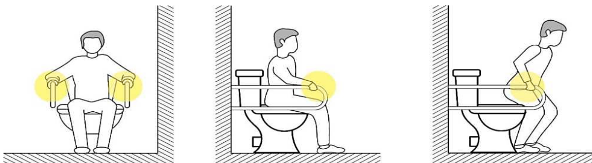
Figura A.6 — Utilizarea părții barei de sprijin orizontale, care iese în fața marginii vasului de toaletă, la ridicarea de pe acesta
