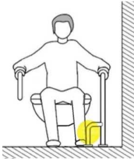
Рисунок А.17 — Опора поручня, создающая помеху при вставании
