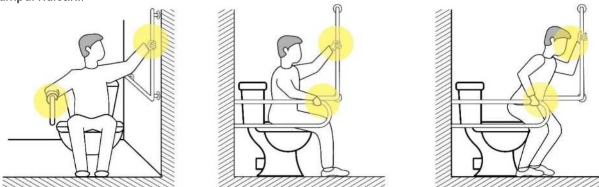
Figura A.5 — Utilizarea barei de sprijin verticale la ridicarea de pe vasul de toaletă
