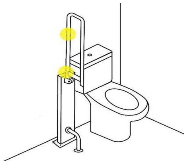
Figura A.18 — Nu este permisă montarea unei bare de sprijin rabatabilă, fără dispozitiv de fixare în poziție verticală
