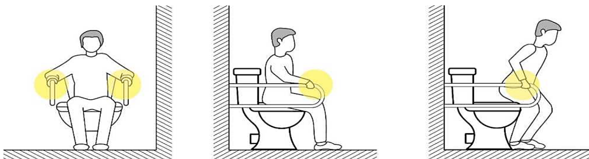
Рисунок А.6 — Использование выступающей за передний край унитаза части горизонтального поручня при вставании с унитаза
