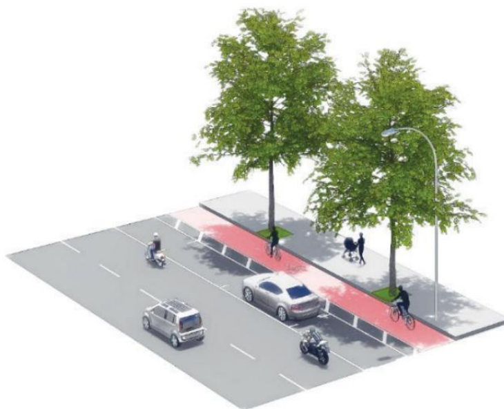
Figura 8 - Exemplu de banda pentru biciclete amplasată între banda de parcare și trotuar [6]
