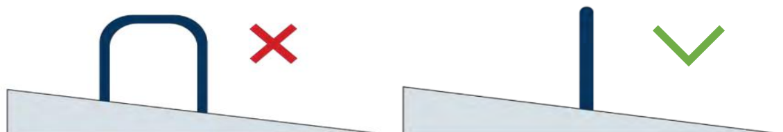
Figura 36 - Exemplu de amplasare a rastelului când suprafața este în pantă. Suportul trebuie orientat drept pe pantă
